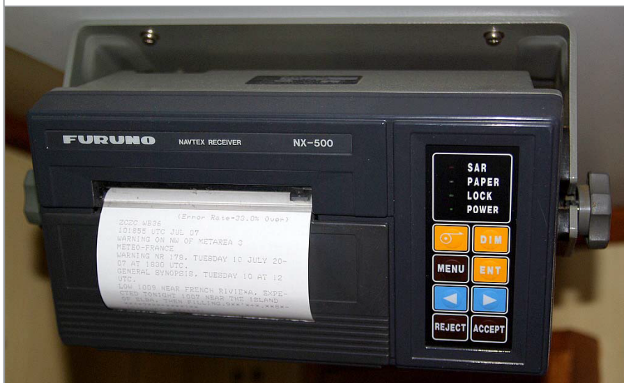
Niektóre odbiorniki NAVTEX umożliwiają wydruk komunikatów
